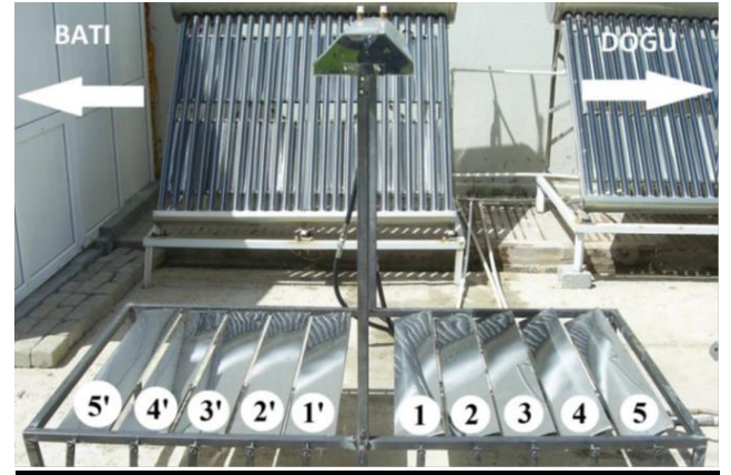
Şekil 6. Doğrusal Fresnel kolektörde aynaların yerleşimi
