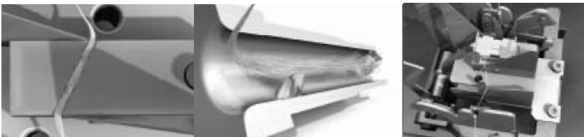
Şekil 1. Standart uç birleştirme mekanizmasında uç birleştirme işlem aşamaları
