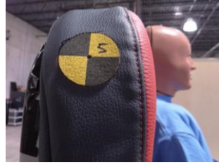
Şekil 4. Dinamik test öncesi tanımlanmış ölçüm noktaları
