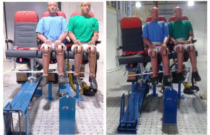
Şekil 5. 0-1-1 şeklinde konumlandırılmış koltuğun deformasyon öncesi ve sonrası durumu
