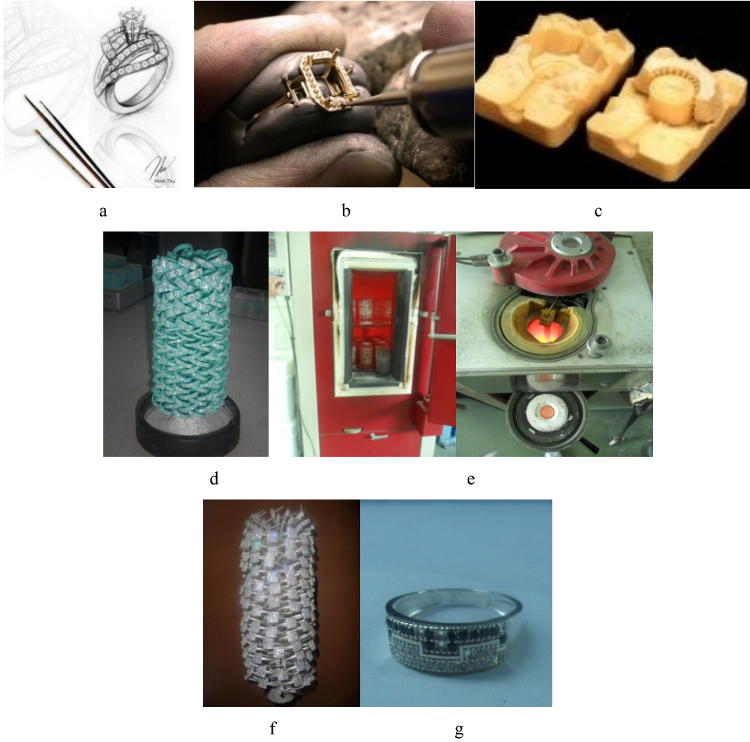
Şekil 1. Takı üretiminde geleneksel yöntem aşamaları; (a) Tasarım eskizi (yüzük örneği) [20] , (b) Tasarımı yapılan modelin bir örneğinin el işçiliği ile yapılması [21], (c) Kauçuk kalıp [22], (d) Kalıplara mum basma işlemi ile elde edilen mum modeller - mum ağacı, (e) Hassas döküm, (f) Model ağacı, (g) Değerli veya yarı değerli taşlar monte edilmiş son ürün
