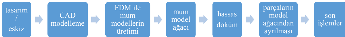
Şekil 6. Kuyumculukta FDM yöntemi ile takı üretimi aşamaları
